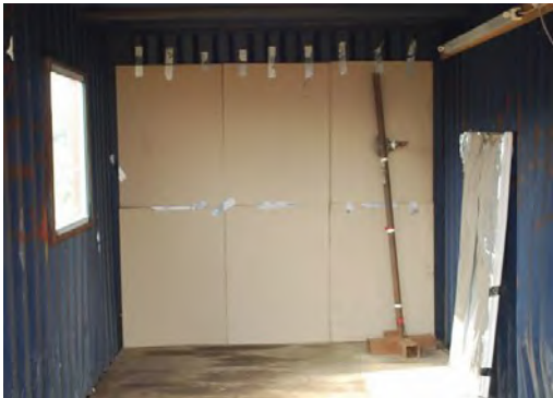
vue intérieure du conteneur montrant le manomètre et le panneau témoin sur la paroi arrière
