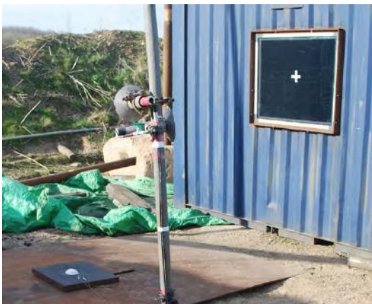
Manomètres externes configurés pour mesurer à la fois les surpressions réfléchies et incidentes
