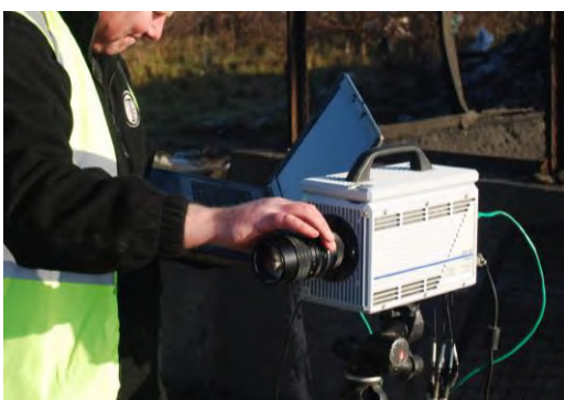
Réglage de la caméra haute vitesse. Tout le tournage était à 1000 images par seconde
