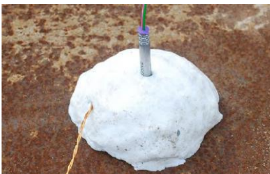
Charge hémisphérique C4 avec détonateur inséré en haut au centre.
